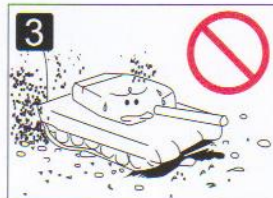
3 在户外泥地沙地、凹凸不平处、灰尘多之处行走造成的故障。
