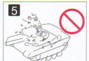
5 在BB弹投入口放入指定BB弹以外物品而堵塞造成的故障。
